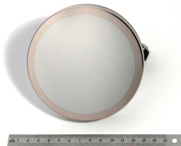
Figure 7 : maquette d'un miroir pour ITER : film de rhodium (5 \mu\text{m} ) sur un substrat en acier inoxydable.
