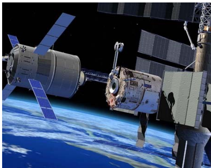
Künstlerische Darstellung des vollautomatischen Andockmanövers des ATV (links) an das russische Service-Modul Zvezda der ISS (rechts). © EADS Astrium.
