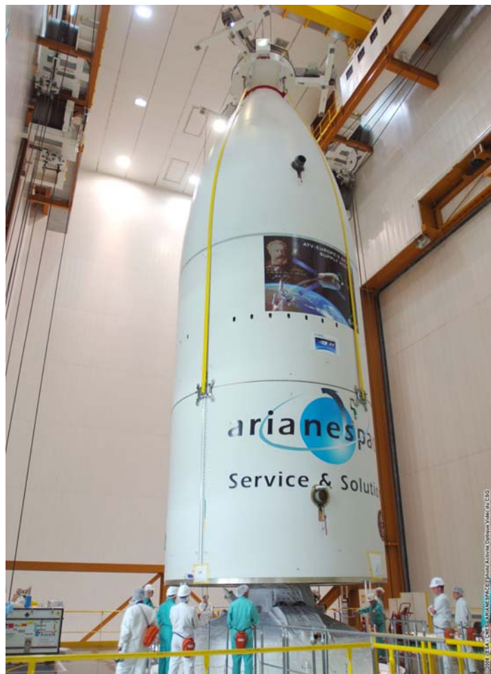
Einkapselung des ATV unter der Nutzlastverkleidung an der Spitze der Ariane-Rakete (L528) in Kourou, Französisch Guyana. © Arianespace
