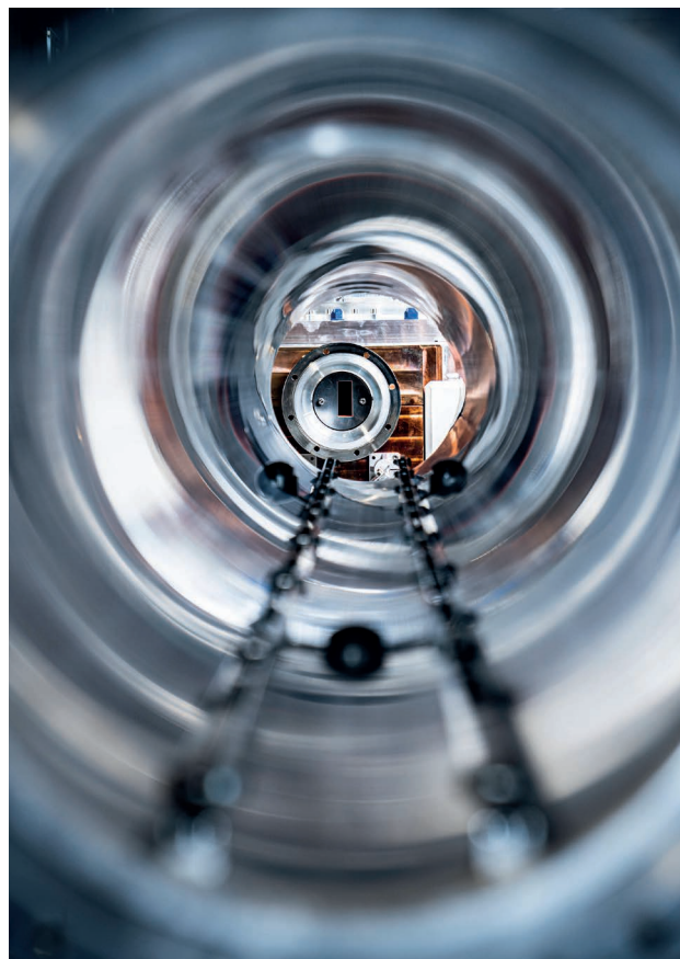
Innenansicht eines Neutronenleiters, der den Neutronenstrahl transportieren und konditionieren wird. Er wurde am Paul Scherrer Institut mit Unterstützung der Schweizer Industrie entwickelt und gebaut. Bild: Artur G. Glavic, PSI
