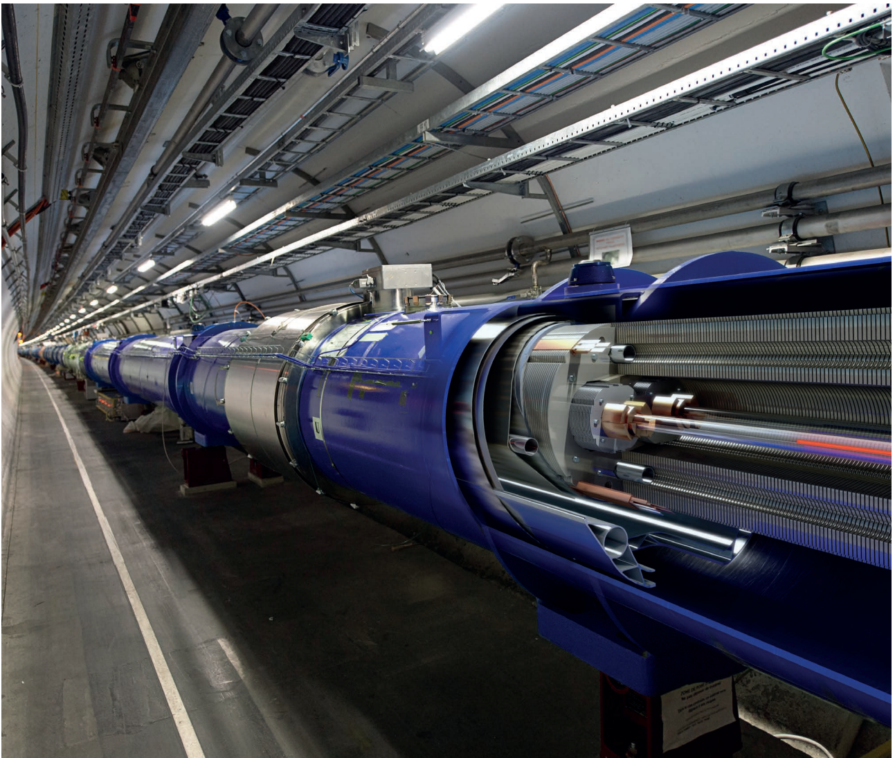
Dreidimensionaler Schnitt durch einen LHC Magneten. Bild: CERN
